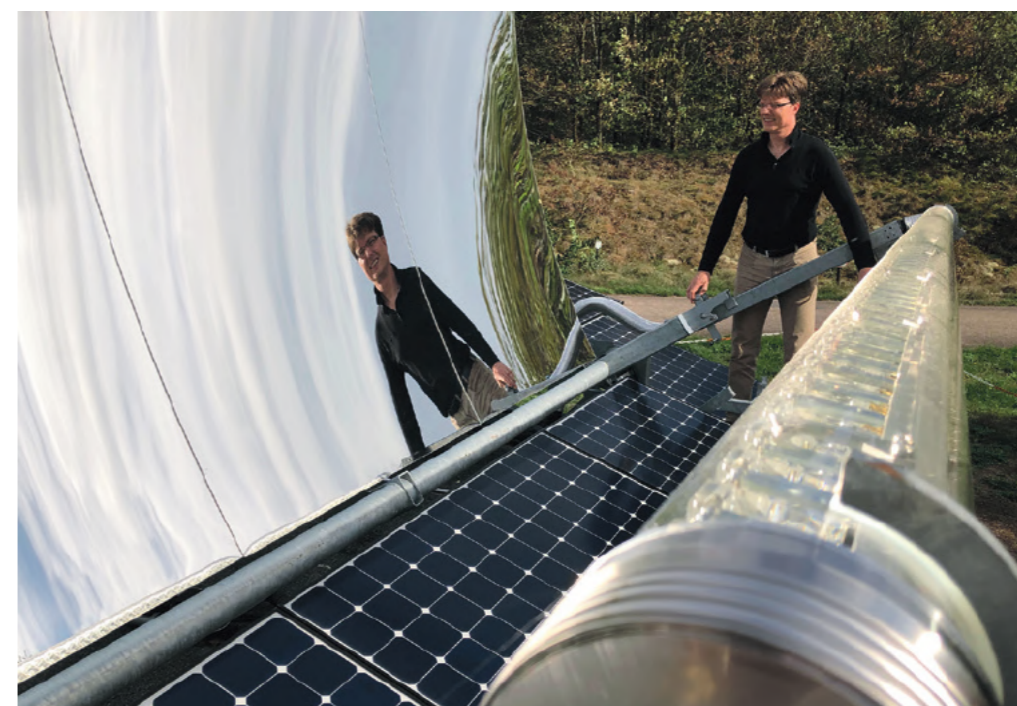
Die patentierte SunOyster folgt nicht nur den ganzen Tag der Sonne, sie schützt die Spiegelflächen auch selbständig vor starkem Wind. (Foto: SunOyster Systems GmbH, Quelle: WEP Report 1/2020)
